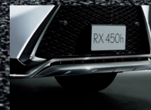
フロントロアバンパーモールド (金属調塗装+メッキ)
